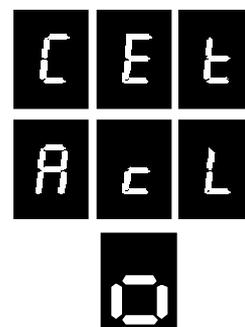
Led Rosso indica lampeggiando uno o più ingressi aperti. Premendo il tasto **O** il led si accende fisso e sul display compare il numero del primo ingresso aperto. Premendo il tasto **1** è possibile scorrere il registro fino all'ultimo ingresso aperto. Si esce dalla procedura ripremendo il tasto **F** o per time out. Gli ingressi di manomissione aperti sono segnalati con la lettera **t**.
