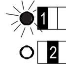
Led 2 indica lo stato del Settore 2: spento: Settore disinserito, acceso fisso: settore inserito
