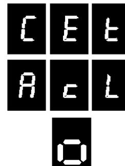
Il led rosso indica lampeggiando uno o più ingressi aperti. Premendo il tasto **O** il led si accende fisso e sul display compare il numero del primo ingresso aperto. Premendo il tasto **1** è possibile scorrere il registro fino all'ultimo ingresso aperto. Si esce dalla procedura ripremendo il tasto **F** o per time out. Gli ingressi di manomissione aperti sono segnalati con la lettera **t**.
